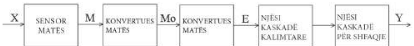
Fig. 7.17. Kaskada matëse për matjen e madhësive joelektrike
