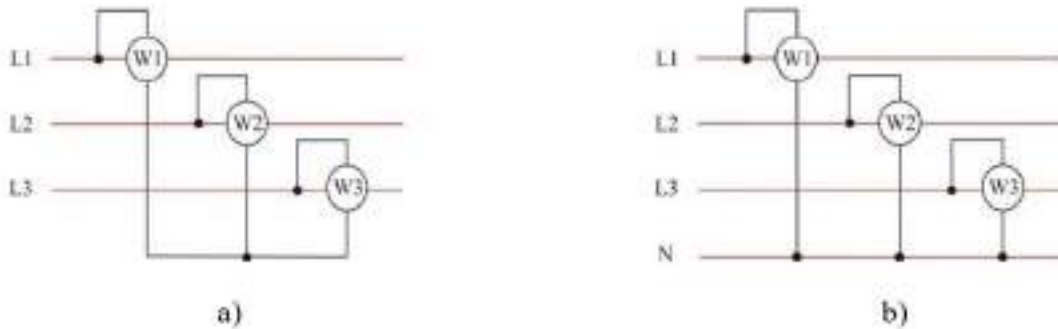
Fig. 7.8. Skema e lidhjes së vatmetrave në sistemin trefazor a) pa përcjelles të zeros dhe b) me përcjelles të zeros
