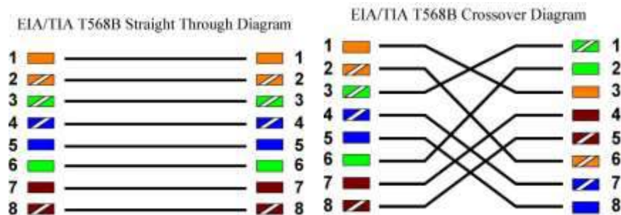
Figura 4.3 Diagrama e EIA/TIA T568B
