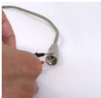
Figura 8.4. Kontrolli me multimetër për lidhje të shkurtër
