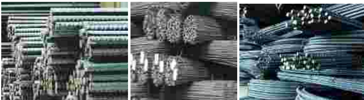
Foto. 12. Shufra hekurbetonime diametra të ndryshëm
